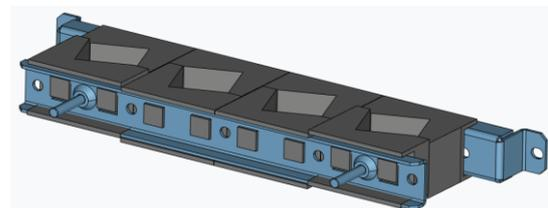
6 Repetir el proceso con el otro soporte de embarrado, colocar las barras de alubar sobre el soporte de embarrado y apretar los tornillos
