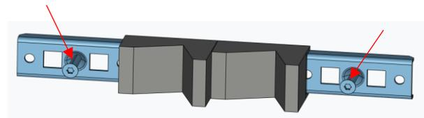
5 Volver a colocar las piezas superior e inferior tapando los tornillos, y volver a unir el soporte de embarrado sin apretar los tornillos
